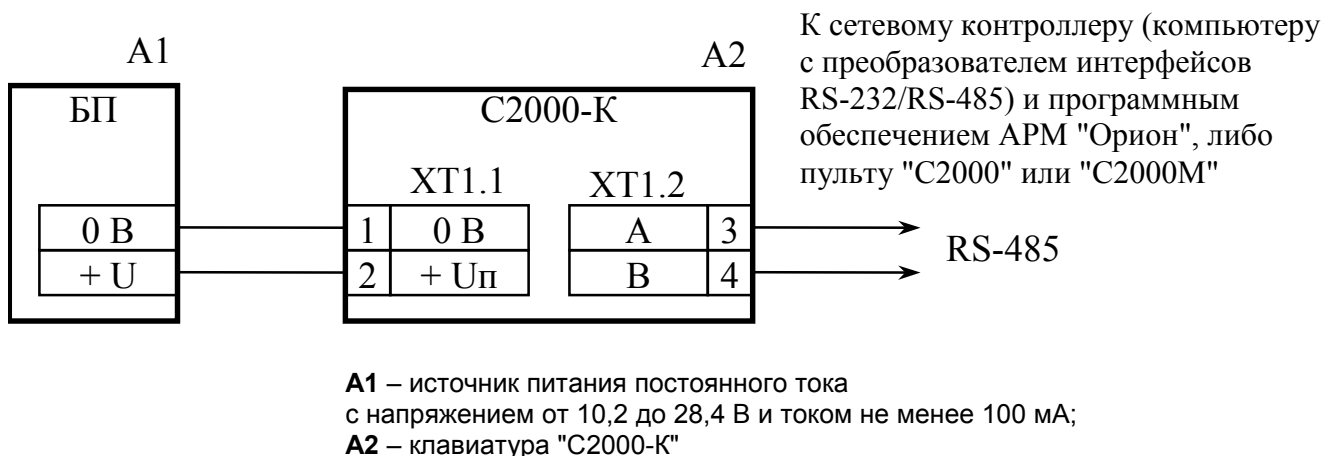
Рисунок 1 Схема подключения клавиатуры "С2000-К" при эксплуатации
