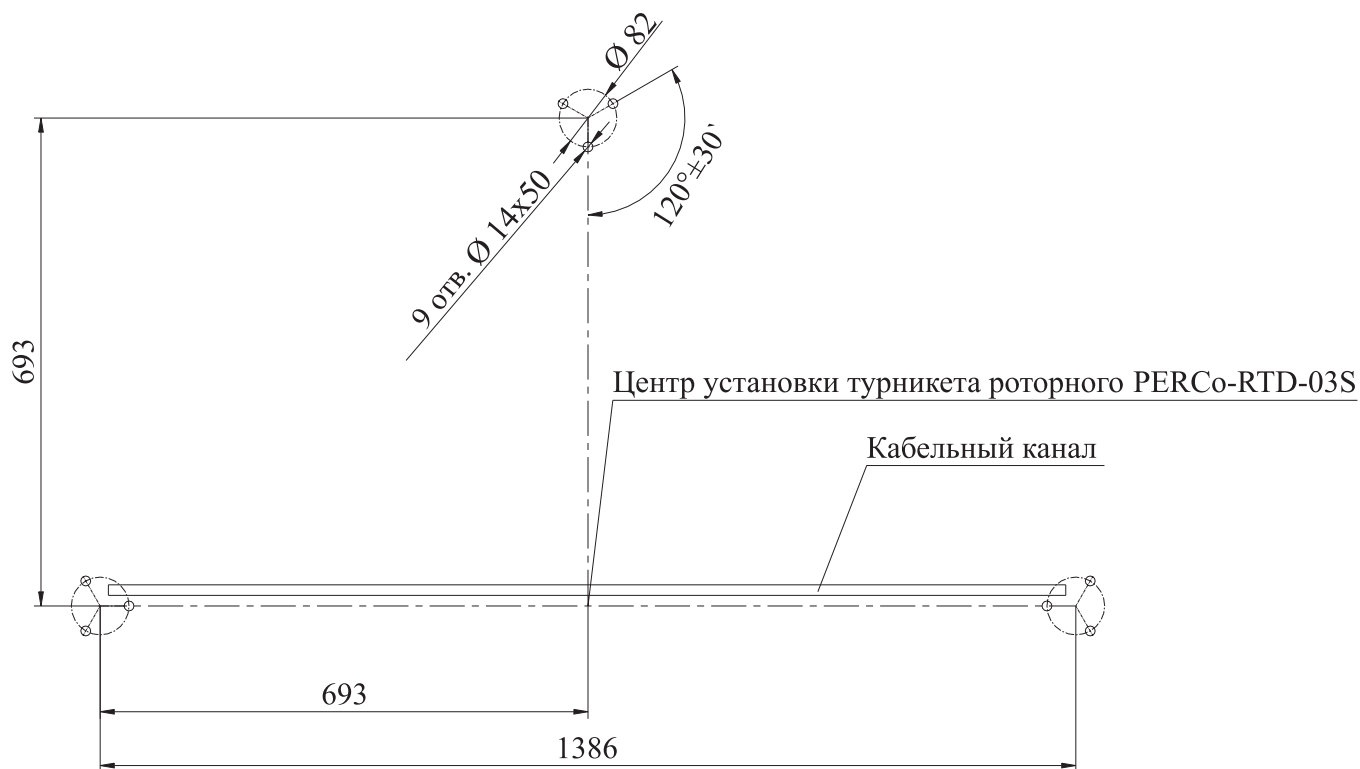
Рис. 3. Разметка для установки стоек формирователя прохода
